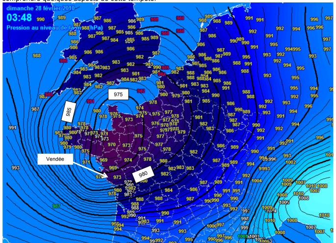
Document 1 - Pressions réduites au niveau de la mer dans la nuit du 27 au 28 février 2010. Les lignes représentent les isobares. Deux isobares sont séparées de 1 mbar. Les lignes épaisses correspondent aux isobares multiples de 5 mbar. On rappelle que 1 mbar = 101,3 Pa = 1,013 hPa et que la pression moyenne au niveau de la mer est de 1 bar.
